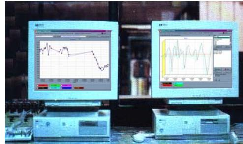
El servidor se basa en una estación de trabajo HP que contiene todo el software necesario para supervisar y controlar sistemas de automatización de subestaciones a nivel regional o nacional.
